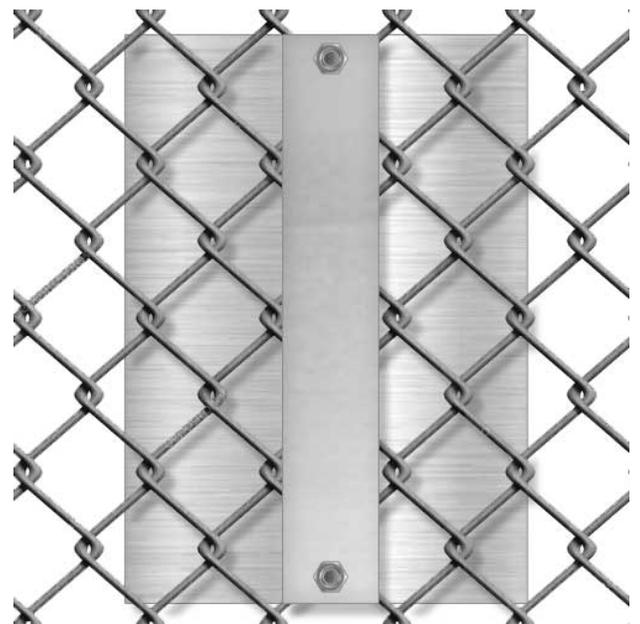
Le résultat doit donner la plaque de soutien sur un côté de la clôture tandis que l'affiche doit se trouver de l'autre côté.
