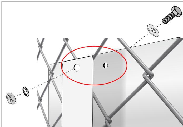
À 2 personnes, placez-vous 1 de chaque côté de la clôture; 1 avec la plaque de support, les boulons et rondelles-coupées et l'autre avec l'affiche, les vis et rondelles.
